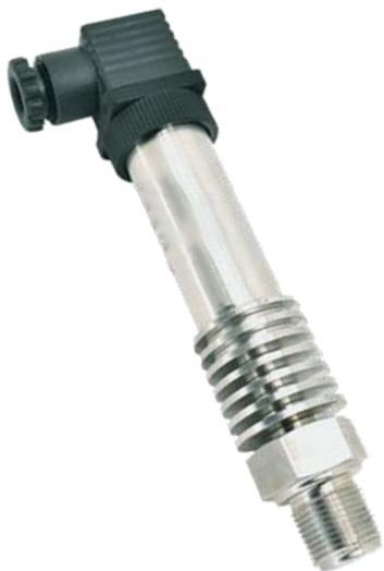
P6013 高温型压力变送器采用不锈钢隔离膜片的硅压阻传感器，并配不同高度的散热片，配合高精度的信号处理电路，经过信号放大，增加抗干扰、防浪涌保护等电路设计，输出标准工业信号，广泛应用于石油、化工、冶金、蒸汽，热能交换的等领域。
